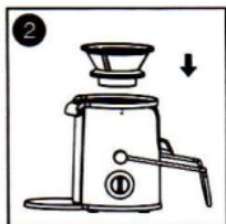
2. Installer et presser le réseau de jus sur le socle milieu suivant la flèche.
